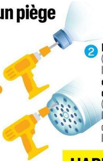
**2** Percer le bouchon (un trou de 8 mm pour laisser entrer les insectes) et le fond de la bouteille (des trous de 6 mm qui laisseront passer l'odeur du mélange qui attirera les frelons).
