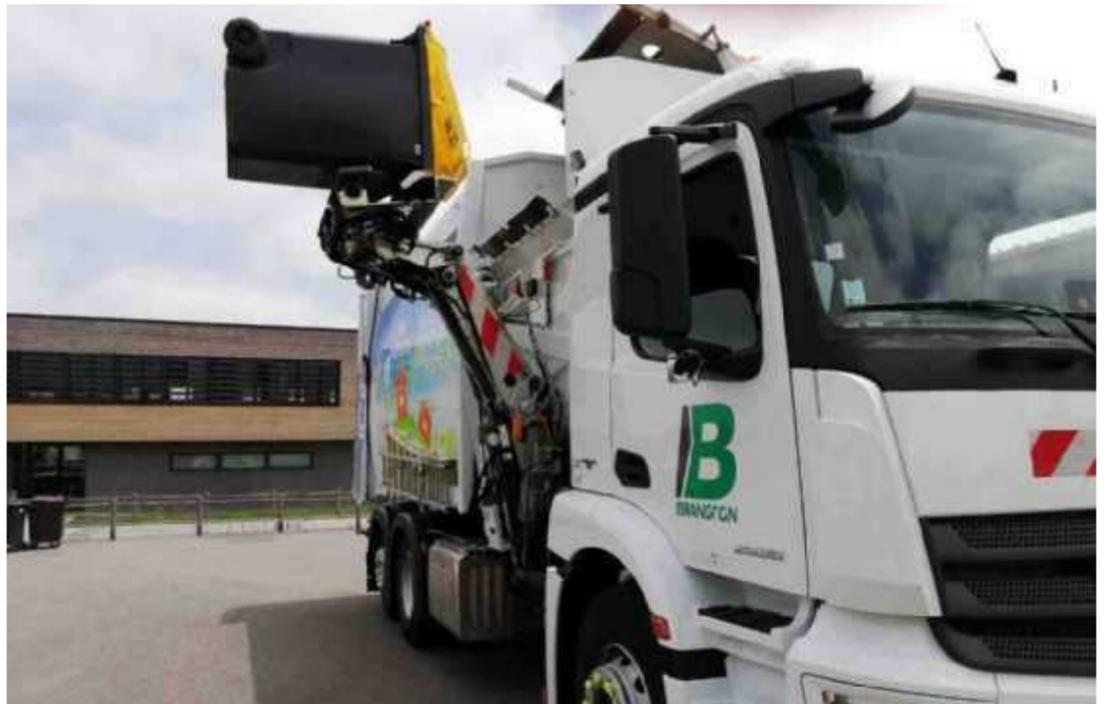
La nouvelle benne à biodéchets se commande depuis la cabine de conduite. Elle sera mise en service en janvier 2020. PHOTO G. R.
